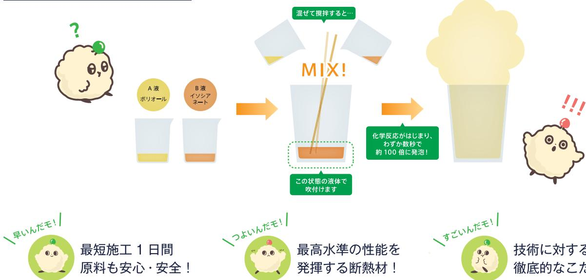
施工期間は最短で1日間と非常にスピーディー。施工する際に有毒ガスを発生させず、吹付けにはフロンガスを一切使用しません。また、ウレタンフォームの原料には、シックハウスの原因とされるホルムアルデヒドをはじめ、その他のVOC(発揮性有機化合物)を含まない安全なものを採用。スピードだけでなく、安心とエコにこだわった断熱材です。
